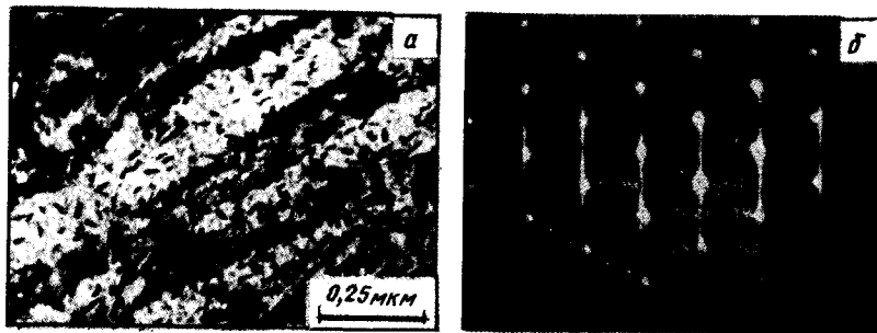
Рис. 2.43. Структура (а) и микроэлектронограмма (б) при -173^{\circ}\text{C} сплава \text{Ti} - 51\% (ат.) \text{Ni} , состаренного при 400^{\circ}\text{C} 4 ч
